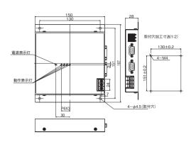
ケース材質 ボンデ鋼板(SPCC-P) (単位:mm)
