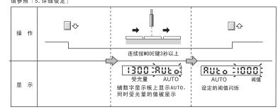
使用对射型光纤时,以无工件的状态进行设定的方法。
